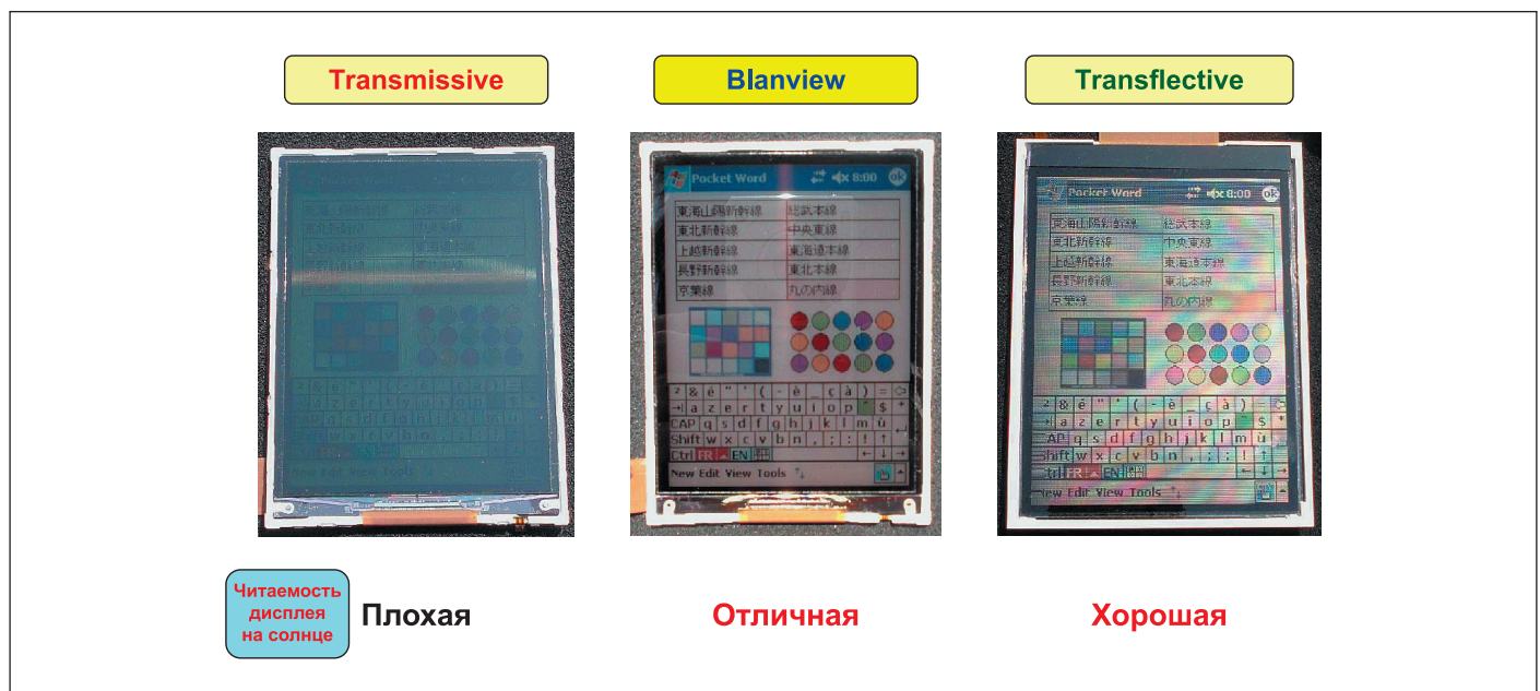
Рис. 7. Сравнение разных типов TFT-LCD при наибольшей солнечной освещенности (100 000 люкс)
